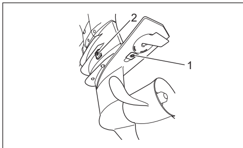
1. Anoda (DF70AT, DF80AT, DF90AT, DF100BT) 2. Anoda (DF70AT, DF80AT, DF90AT, DF100BT z kolumną X)
