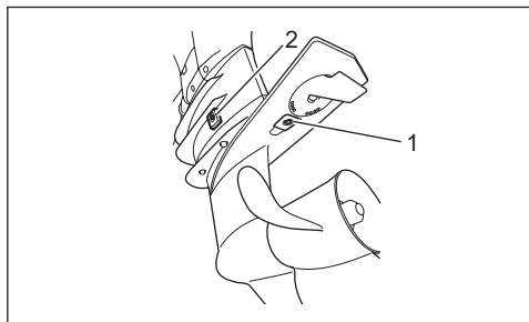
1. Anoda (DF70AT, DF75RT, DF80AT, DF90AT, DF100BT) 2. Anoda (DF70AT, DF75RT, DF80AT, DF90AT, DF100BT z kolumną X)
